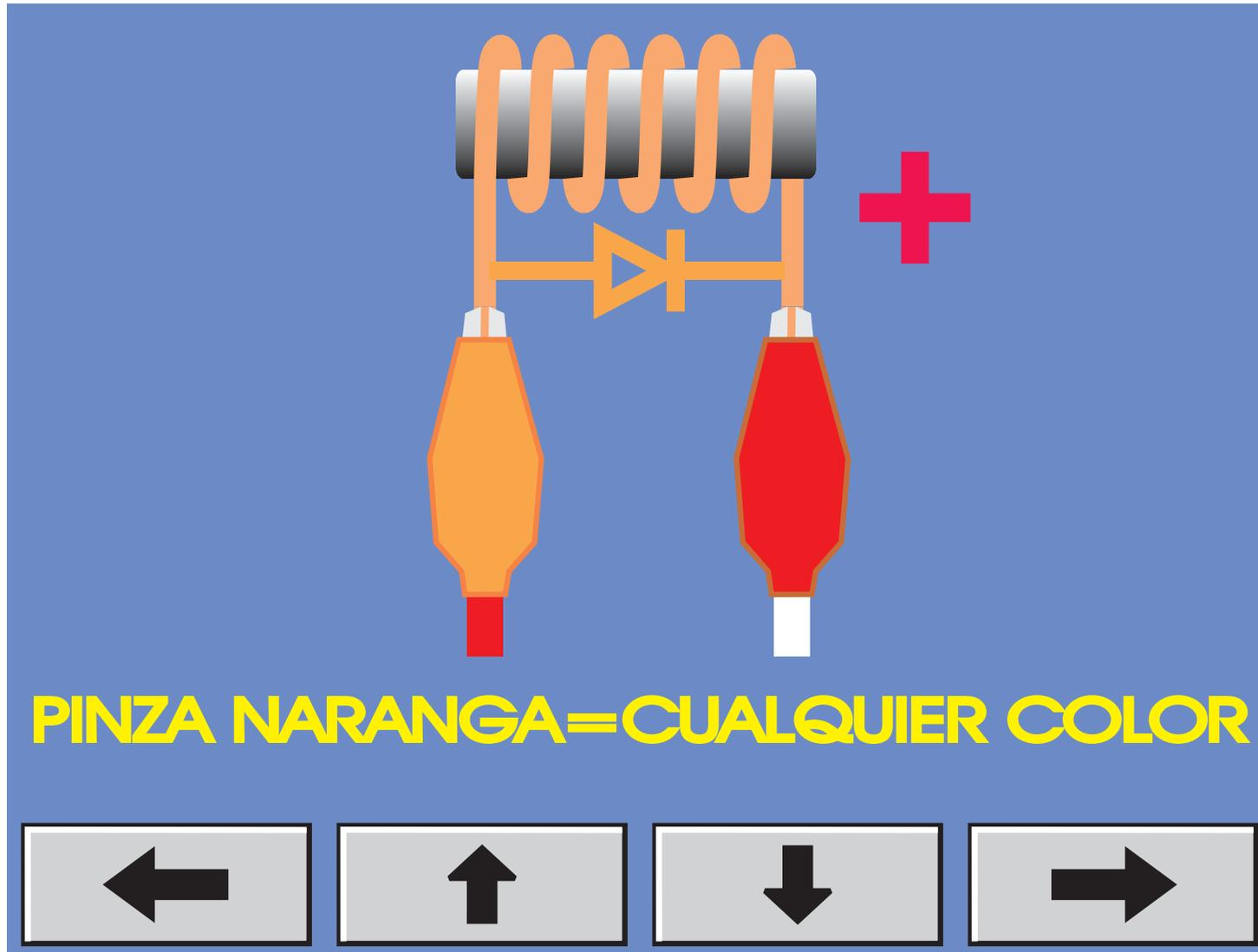
En el dibujo, vemos que tenemos un nuevo cable que es el cable blanco con clip rojo (BR). Esta salida corresponde a 12VCC y es muy usada para poder probar cuatro inyectores multipunto simultáneamente.
