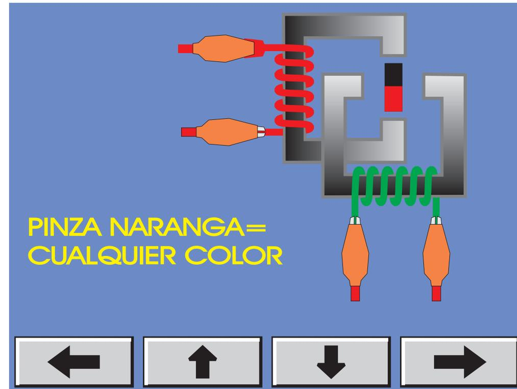
Como indica la leyenda en la pantalla, el terminal dibujado con el cable rojo y clip naranja, es cualquier color, es decir que podemos poner indistintamente cualquier cable rojo independientemente del color del clip en cualquier posición.
