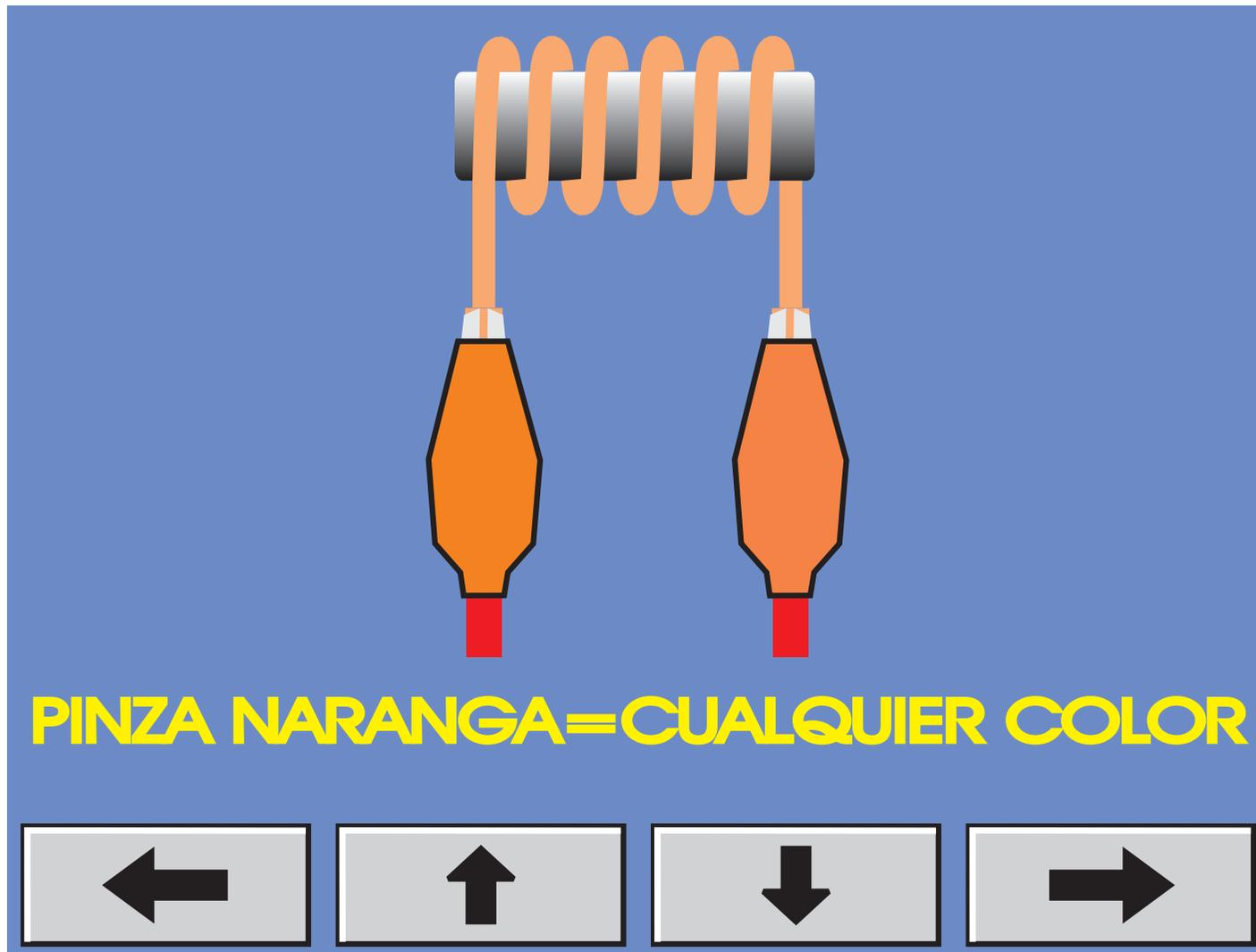
El equipo detectará automáticamente los cables del solenoide e indicará el conexionado del mismo. Por Ejemplo:
