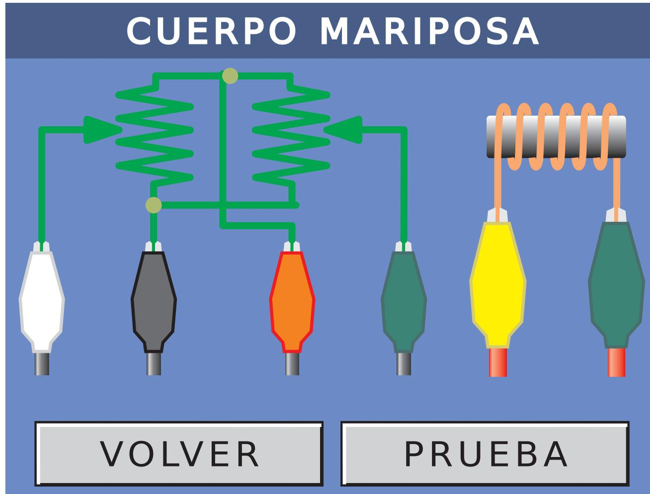
Verificamos el conexionado y luego presionamos sobre el botón PRUEBA para pasar a la siguiente ventana:
