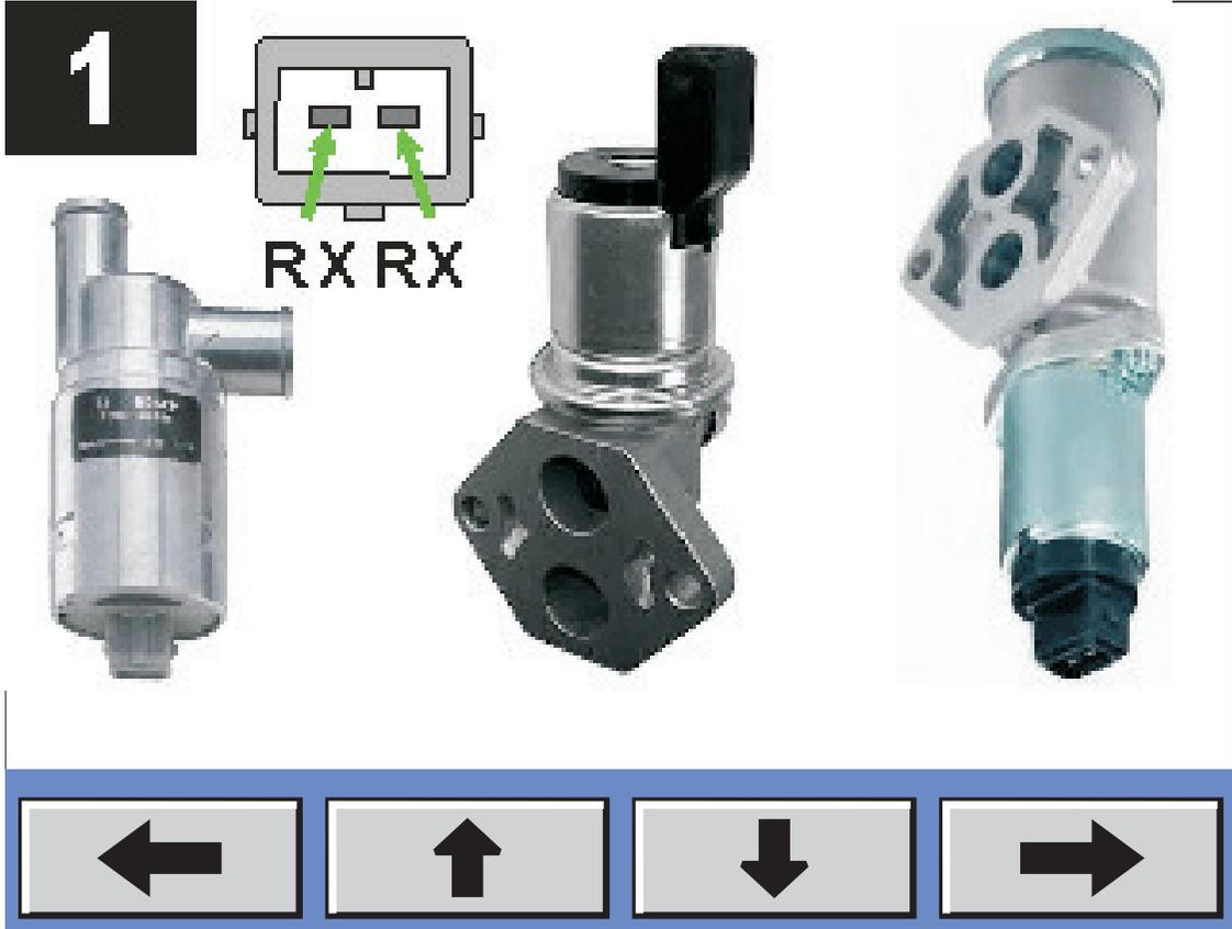
Hacemos el conexionado (ver “nomenclatura de terminales” en el índice) y luego presionamos avanzar
