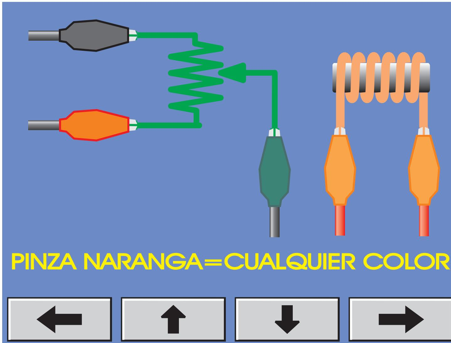
El equipo detectará automáticamente los cables del solenoide e indicará el conexionado del mismo. Por Ejemplo:
