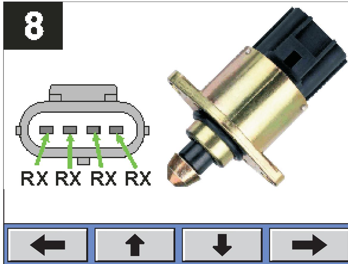
Una vez que el SC-63LED determine el conexionado, lo mostrará en la pantalla con el color correspondiente a cada salida.
